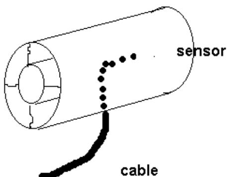
El sensor de temperatura ambiente también puede ser ubicado en el interior de un abrigo de este tipo. Este dispositivo se puede construir partiendo de caños de 5 y 10 cm de diámetro cloacales.
